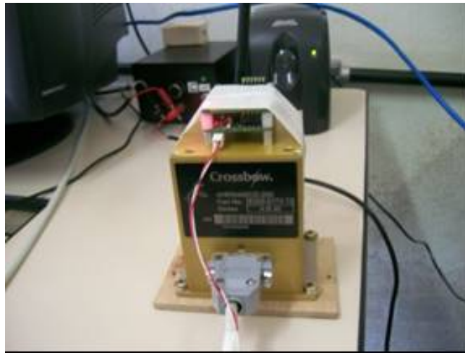
Fig. 5. Plataformas Crossbow e Sparkfun fixadas para calibração.
