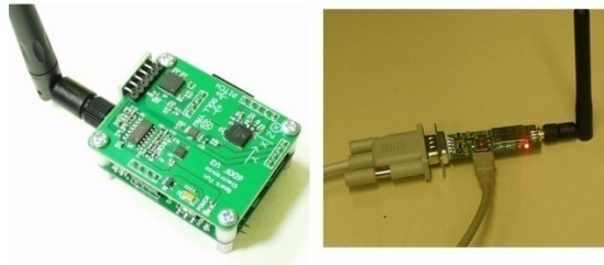
Fig. 2. Plataforma inercial Sparkfun constituída de circuito transmissor com sensores (esquerda) e circuito receptor (direita).
